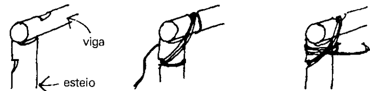
amarrando uma viga ao poste de apoio
