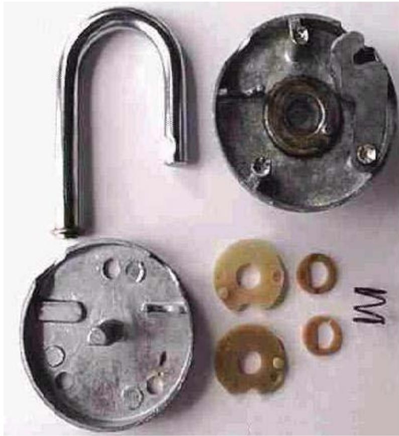
Há três cams numa fechadura de combinação típica. Neste cadeado um do cams é metal e é ligado diretamente ao rosto de desvio do cadeado. O outro dois cams, são plástico. Há dois espaçadores plásticos que assentam entre o cams:
