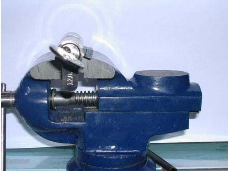
Para testar a bumping key, prendemos a fechadura firmemente no torno e inserimos a chave.
