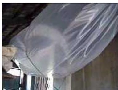
**Photo 17.** Uma corda em volta do tubo está usada para aumentar a pressão de gás
