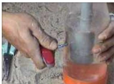
**Photo 12.** O tubo de PVC está colocado dentro da garrafa e um pequeno buraco está feito para definir o nível de água
