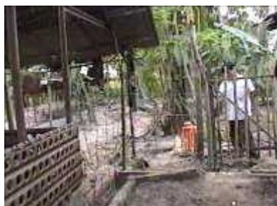
**Photo 18.** Uma cerca ao redor do biodigestor para proteger o plástico
