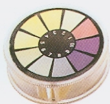
A la izquierda, el papel ph, disponible en farmacias. A la derecha, mucho más preciso, un pHmetro profesional, pHEP2: indica el pH y la temperatura del extracto
