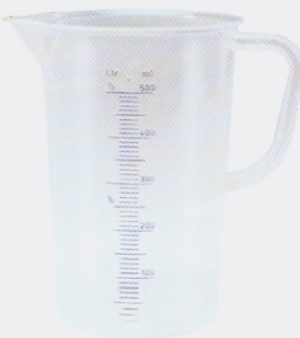
Un vaso medidor, de utilidad para diluir con precisión los extractos en el momento de preparar los tratamientos
